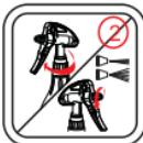
2. Затяните узел, обеспечив герметичное закрытие. Настройте рассеивающую гайку, вращая ее вокруг своей оси
